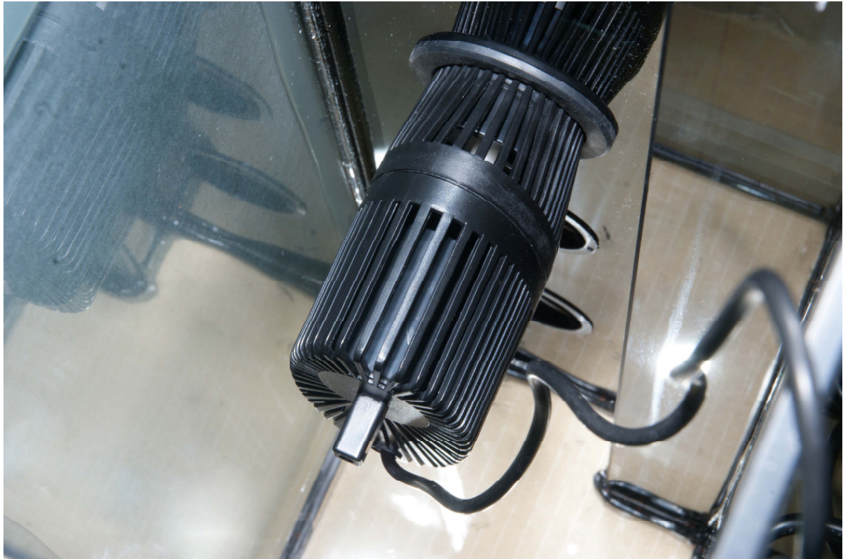
Photo 2: Pompe de brassage
